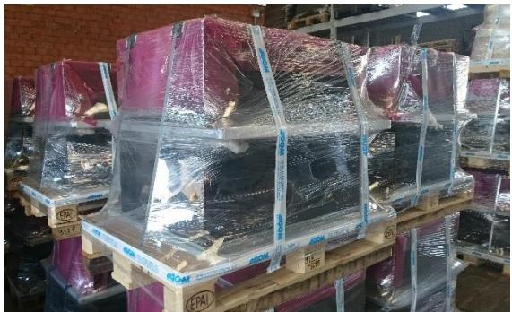
A causa di condizioni imprevedibili, che potrebbero verificarsi durante il trasporto o la movimentazione in loco, l'allineamento e la preregolazione (se applicabile) dell'appoggio assemblato dovrebbero essere confrontati con il disegno. Eventuali discrepanze non devono essere rettificate in sito. Gli appoggi troppo pesanti per essere sollevati a mano devono essere adeguatamente imbracati prima di utilizzare dispositivi per il sollevamento.
