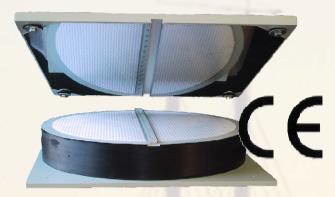
Gli appoggi ponte E-Link Agom sono progettati per poter supportare carichi verticali e nel contempo permettere deformazioni e spostamenti e rotazioni lungo ciascuno degli assi. Gli appoggi elastomerici Agom possono essere realizzati in sola gomma oppure essere rinforzati con piastre in acciaio per aumentarne la capacità di resistenza ai carichi verticali e trasversali.
