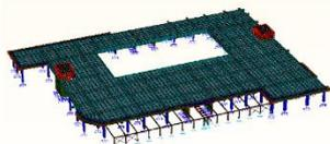
Fig. 1.4 - vista estrusa del modello di calcolo della autorimessa
