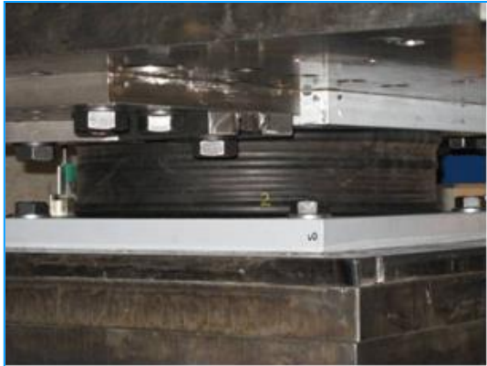
Isolatore sottoposto ad un severissimo test di carico verticale: tre volte il carico di progetto
